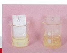
相对比市场普通材料B，YF系列的滤芯材料A经过特殊处理，疏水，疏油性好，保持气体流速畅通，减少提前堵塞的风险，压降和能源浪费
